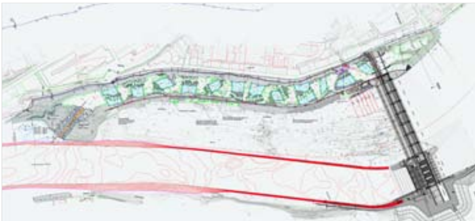
Das Aufstiegs-gewässer wird nach genauen Plänen gebaut. Die Zeichnung zeigt die Lage der einzelnen Kiesinseln.
