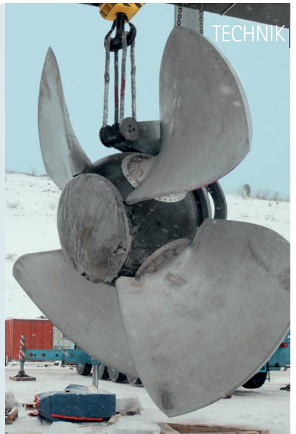
Das Laufrad wiegt 60 Tonnen und wurde in einem Stück angeliefert.
