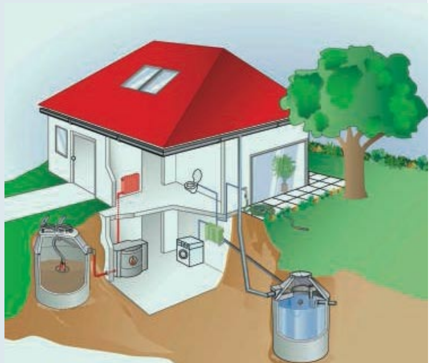
Beispiel für die Nutzung von Regenwasser und die Pelletslagerung im Einfamilienhaus.
